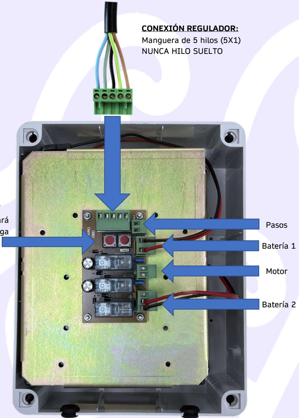
Si el sentido de giro no coincide con las órdenes del ordenador, habrá que cambiar el orden de los cables del motor.
